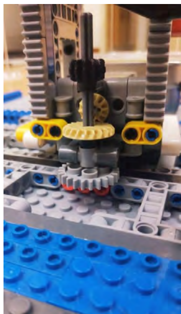
▲ 圖 15 水平旋轉機構的固定和傳動方式
